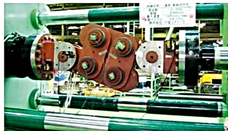
نمونه تست انجام شده روی میراگر اصطکاکی دورانی
