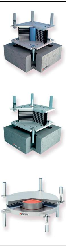
جداسازهای hot-vulcanized rubber و Steel Laminate (LRB) Lead Rubber Bearing از لایه‌های میزان انرژی میرا شده بواسطه تسلیم هسته سربی معادل میرایی ویسکوز ۳۰ درصدی می‌باشد که به واسطه آن مقدار کاهش جابجایی در این سیستم نسبت به سایر سیستم‌ها با سختی برابر بیشتر می‌باشد. جداسازهای شرکت FIP تمام ضوابط آینه‌نامه‌های معتبر بین‌المللی را برآورده کرده و مرکز کنترل داخلی شرکت FIP کیفیت مواد و ساخت تمام محصولات این شرکت را تضمین می‌کند به نحوی که دارای بالاترین کیفیت تجهیزات در بین نمونه‌های مشابه می‌باشد.
